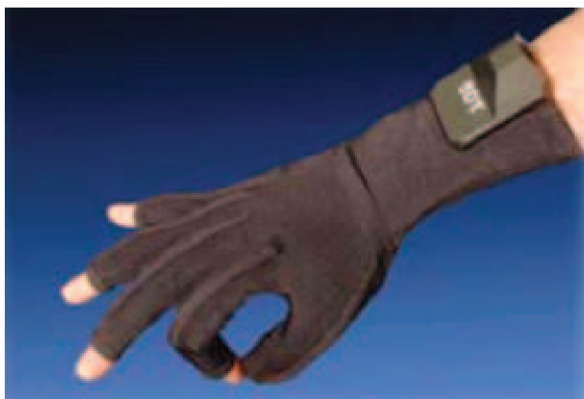
FIGURE B.4: Un gant de données 5DT disposant de quatorze capteurs
