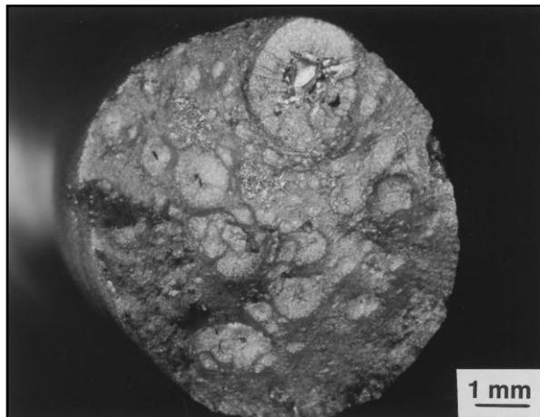
Figure 5-1 : *Fisheyes* sur la surface de rupture d'une éprouvette de traction [Woodtli & Kieselbach 00]
