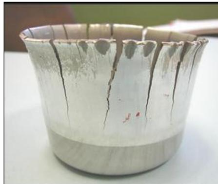
Figure 1-14 : Rupture différée d'un godet en acier TWIP [Scott et al 09]
