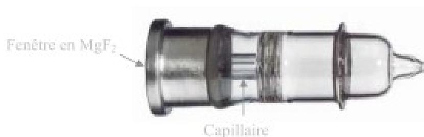
**Figure 4** : Lampe de photoionisation Cathodeon™ utilisée avec la source d'ions APPI
