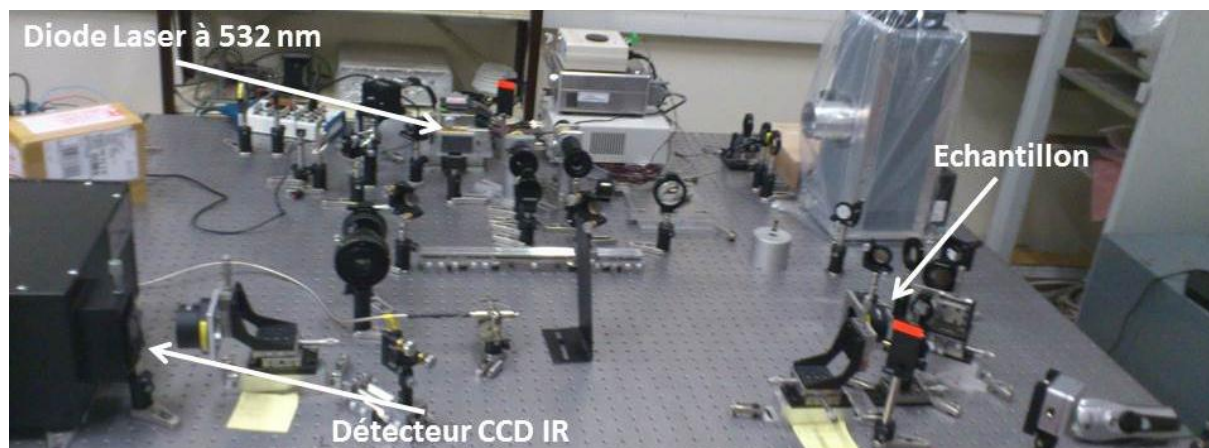
Figure 3.1.8 : Système optique de laser / CCD / miroirs / diaphragmes / lentilles utilisé afin de focaliser le faisceau sur un échantillon dans une cuve en quartz de 1mm et de détecter l'émission des nanotubes de carbone qui y sont présents.
