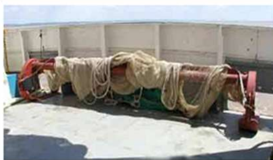
Figure 16. Engins d'échantillonnage pour la DCE : un chalut à perche de 3 m (Lepage et al. 2010).
