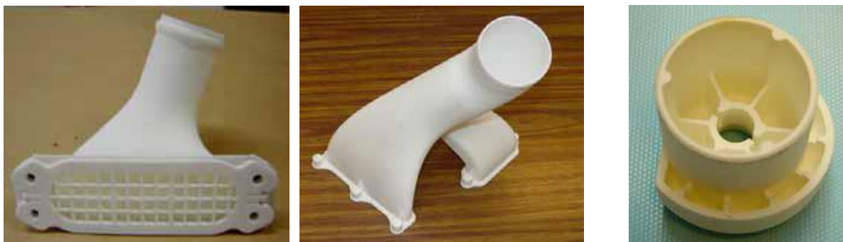
Figure 1 Pièces thermoplastiques obtenues par fusion laser sélective équipant des avions Dassault Aviation, AEPR 2008
