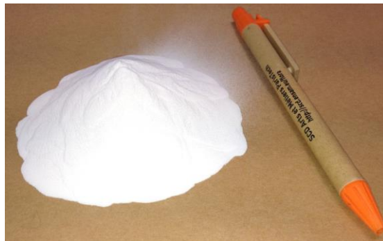
Figure 3 Poudre de PA12 utilisée par Dassault
