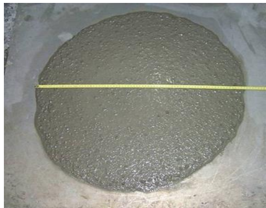
Figure II-11 : Essai d'étalement pour le BAP.
