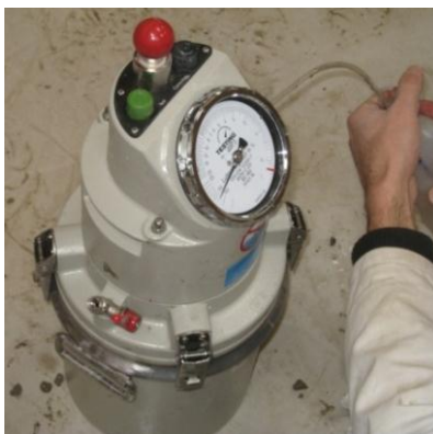
Figure II-14 : Aériomètre pour béton.
