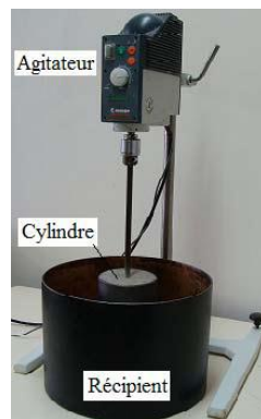
Figure I-18 : Tribomètre à cylindres coaxiaux de Ngo [14].
