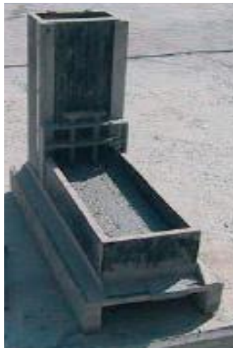
Figure II-12 : Essai de la boîte en L.
