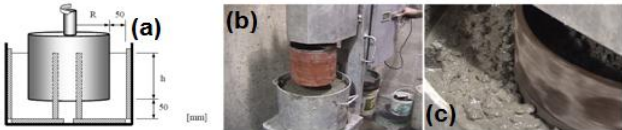
Figure I-17 : (a) Croquis du tribomètre, (b) vue générale avec tribomètre en caoutchouc et (c) vue de près avec tribomètre en acier en mouvement [43].
