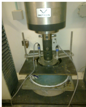
Figure 5.1: Dispositif expérimental : presse INSTRON 150 kN
