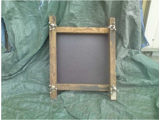
Fig. VI- 26: caisse en béton projetée
