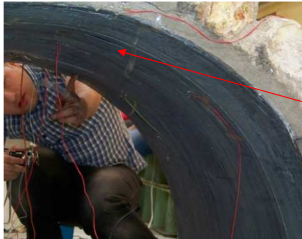
Fig. VI- 20: début de décollement des tissus de carbone
