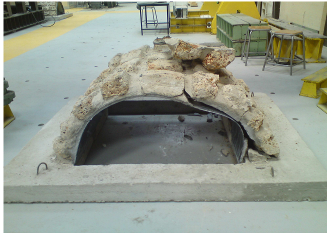
Fig. VI- 15: voûte renforcée par des plats de carbone
