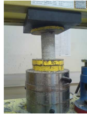
Fig. VI- 28: essai de compression
