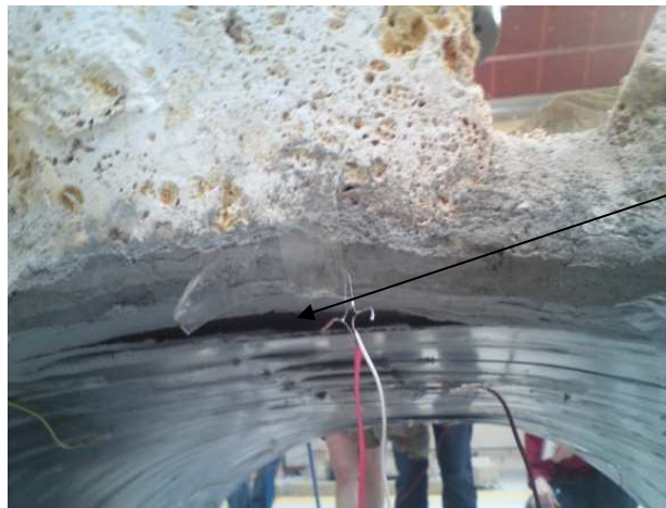
Fig. VI- 14: décollement des plats (P1 et P2)
