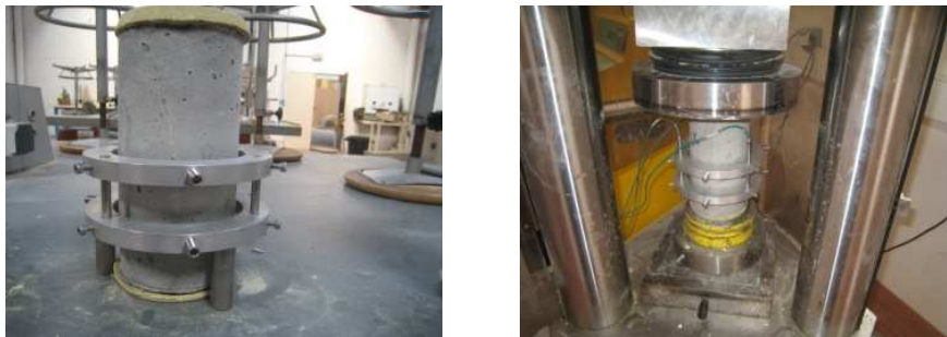
Fig. III- 9: principe de l'essai de Module de Young
