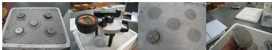
Fig. III- 7: principe de l'essai d'arrachement
