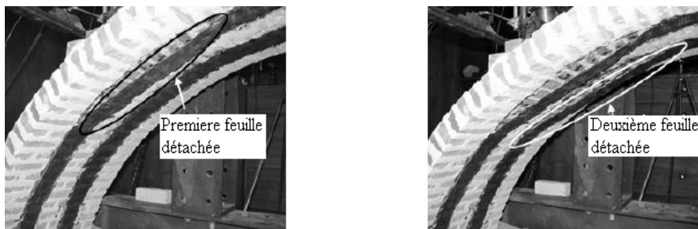
Fig. II- 40: mode de la rupture
