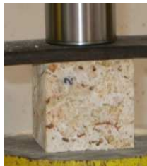
Fig. III- 15: essai sur éprouvettes cubiques
