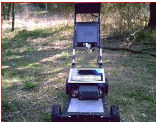
Fig. I- 5 : auscultation par radar géophysique
