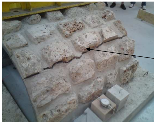
Fig. VI- 13: fissurations au niveau des reins à l'extrados (P1 et P2)
