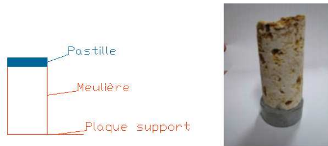
Fig. III- 16: rupture lors des essais d'arrachement par traction directe
