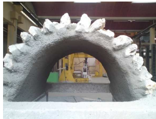
Fig. VI- 29 : projection et voûte finie
