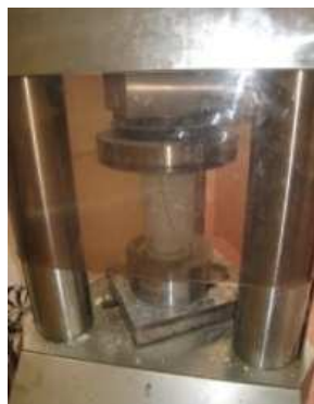
Fig. III- 3 : principe de l'essai de compression (4)
