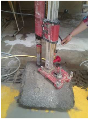
Fig. VI- 27: carottage des éprouvettes 6x12 cm2
