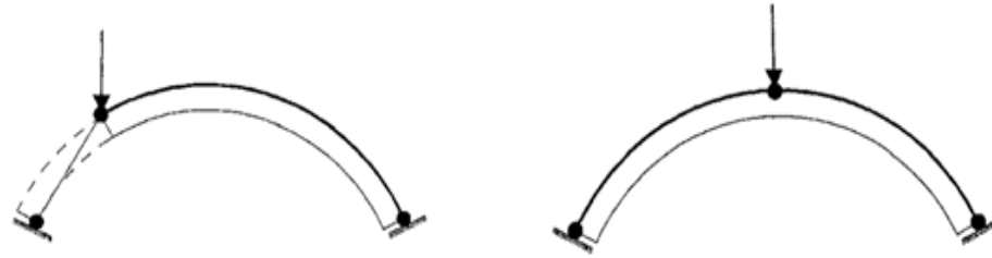
Fig. II- 27: arcs renforcés à l'extrados par les matériaux composites
