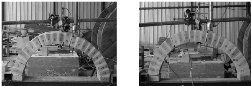
Fig. II- 48 : fissuration dans les joints du mortier
