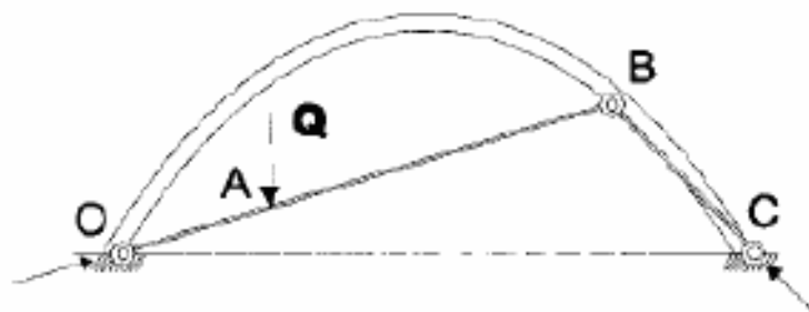
Fig. II- 19: schéma statique pour le renforcement à l'intrados
