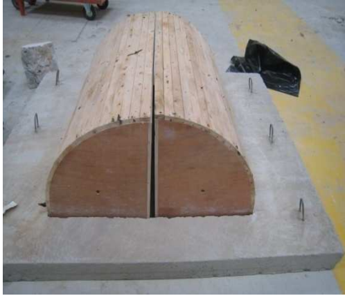
Fig. IV- 5: coffrage en bois
