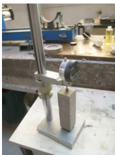
Fig. III- 10: mesure du retrait
