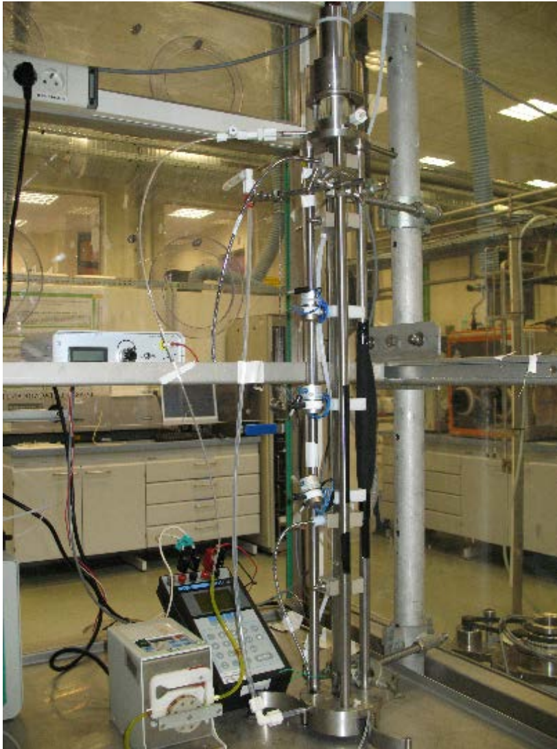
FIGURE 5.4: Photo du montage DTS : colonne extracteur ( \eta = 0,85 ).
