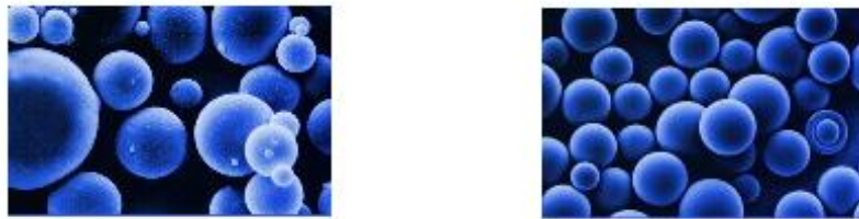
FIGURE 2.13: Traceurs PIV : Sphères en verre à gauche et particules en rhodamine à droite .
