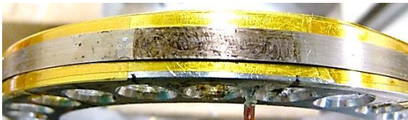
12- Ajout d'un ruban de Kapton pour maintenir l'échantillon en place et améliorer la répartition de la charge
