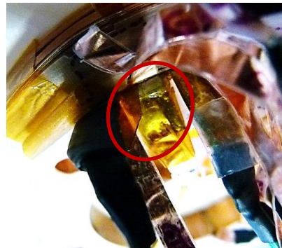
(b) - Insertion d'une feuille de Kapton pour corriger la déchirure de l'isolant de la chaufferette.
