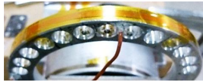
12- Ajout d'un ruban de Kapton pour maintenir l'échantillon en place et améliorer la répartition de la charge
