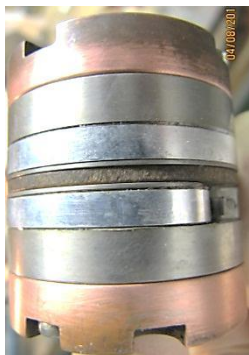
3- Bobinette avant la réalisation de la jonction (galettes séparées par une plaque de G10)
