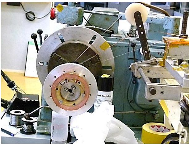
2- Fin de bobinage d'une galette simple
