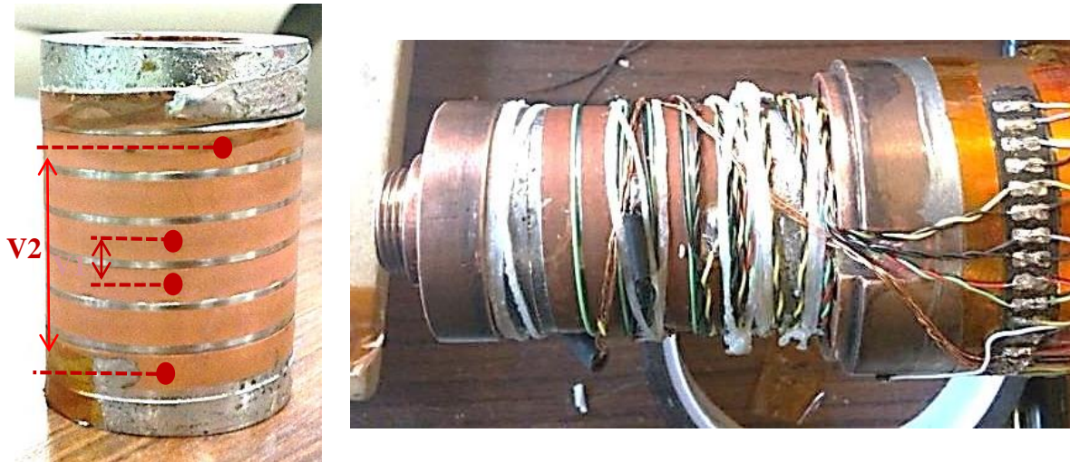
Figure 3-1 : Echantillon VAMAS fabriqué à partir du ruban SCS4050-AP (à gauche) et échantillon monté sur le porte échantillon (à droite).
