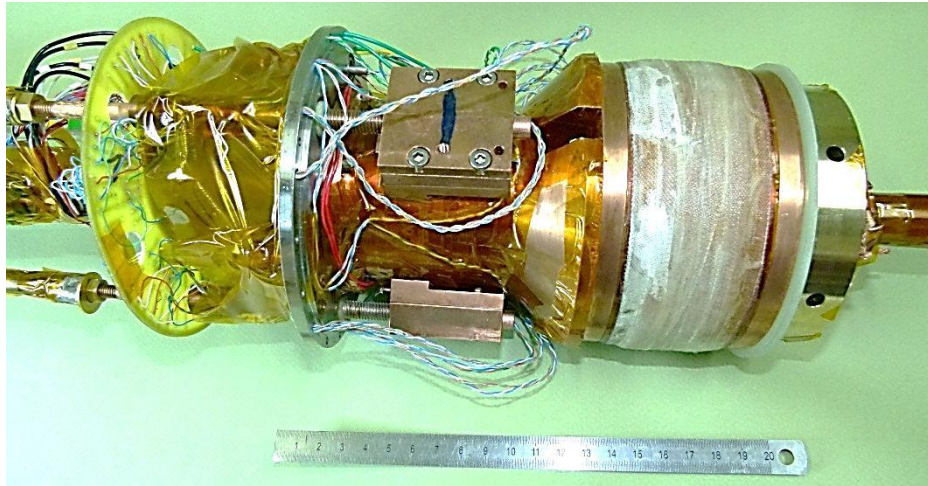
f- Bobine finale sur le porte échantillon du LNCMI
