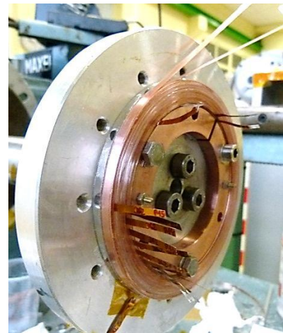
5- Fin du bobinage d'une GI
