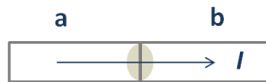
FIGURE 1.2: Effet Peltier : passage d'un courant I à travers une jonction entre deux matériaux a et b.
