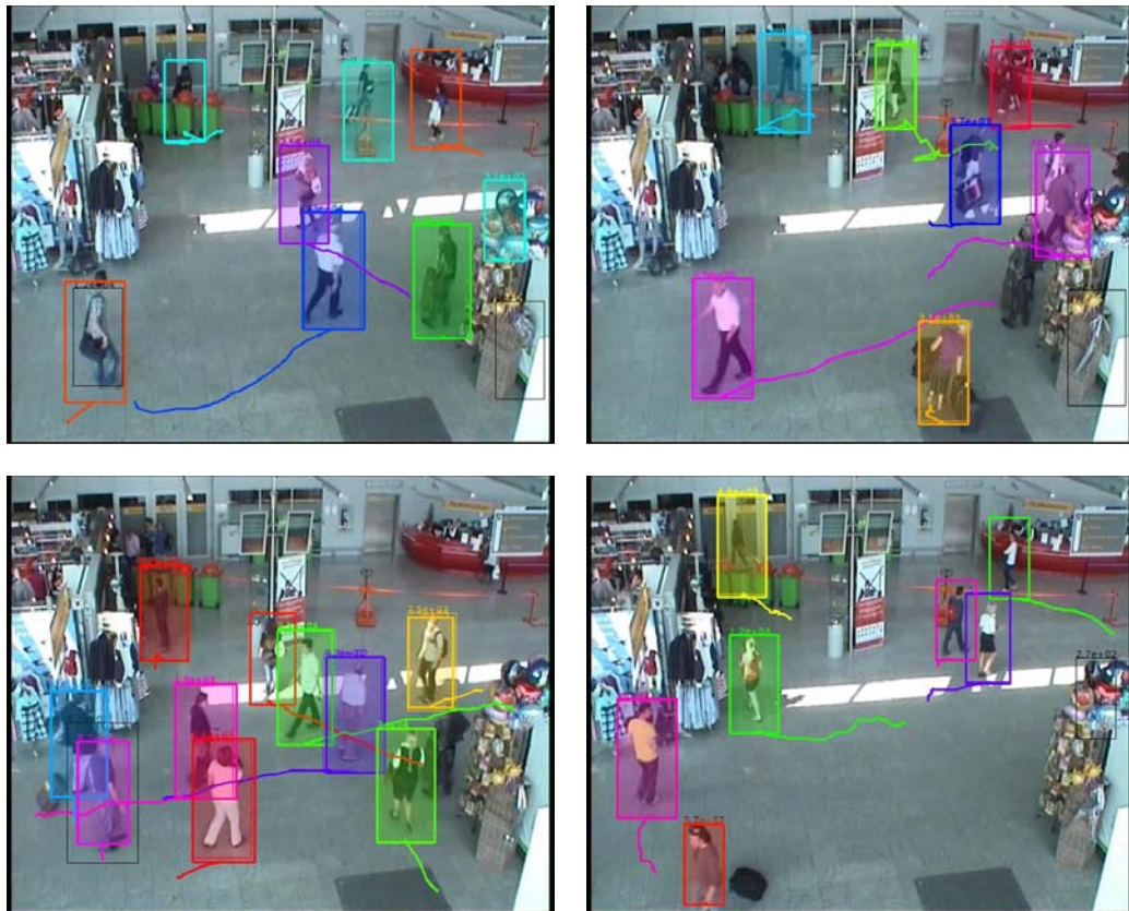
FIGURE 4.13 – Résultats issus de notre tracker sur ViCoMo 1. Les trackers sont indiqués par des boîtes et des trajectoires en couleurs. Un tracker associé à une détection est représenté par une boîte entièrement colorée, sinon seul le contour de la boîte apparaît. Les détections non associées sont représentées par des traits noirs et plus fins.
