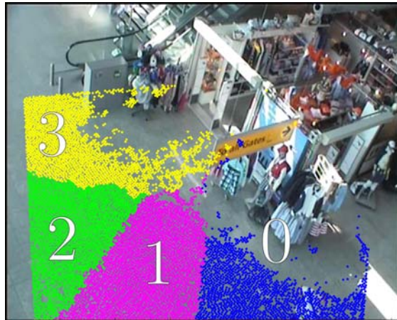
FIGURE 5.12 – Découpage de la scène réalisé par l'algorithme des superpixels.
