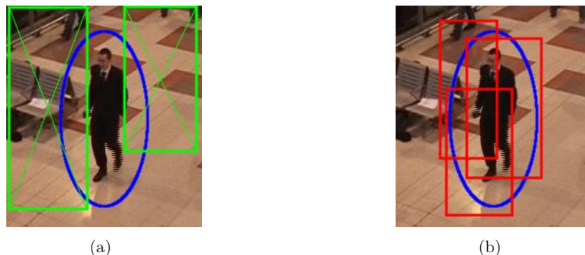
FIGURE 3.7 – Métrique pour comparer les détections à la vérité terrain. (a) Ces deux boîtes n'ont pas leur centre dans l'ellipse. Il s'agit de deux faux positifs. (b) Toutes ces boîtes ont leur centre dans l'ellipse. Il s'agit d'une bonne détection.
