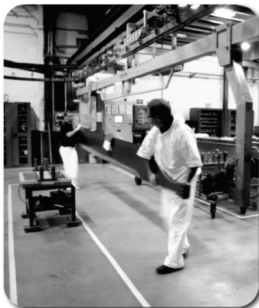
Figure 35 : La pièce est extraite du rail aérien pour être posée sur un chariot à roulettes, situé derrière l'opérateur au premier plan
