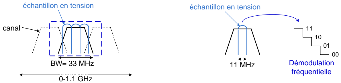
FIGURE 3.3.6 – Illustration de la démodulation fréquentielle d'un signal QPSK effectuée par le SASP
