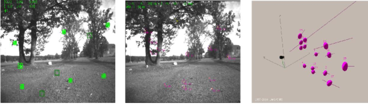
FIGURE 4.4 – Zones de recherche à  $3\sigma$  centrées sur la prédiction dans l'image. *A gauche*, image issue de *CSLAM*, où la zone de recherche est définie par un rectangle. *Au milieu*, image issue de *RT-SLAM*, où les zones de recherche sont représentées par des ellipses. *A droite*, les zones d'incertitude adoptent une représentation en 3D offerte par *RT-SLAM*.
