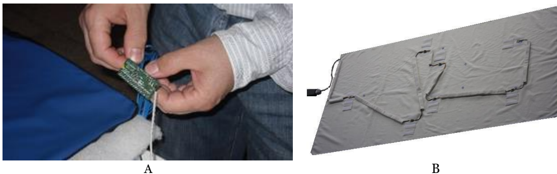
Figura 38A- Pormenor dos trabalhos iniciais da integração da estrutura electrotêxtil num protótipo de 1ª geração; 38B - Detalhe da camada intermédia da estrutura electrotêxtil de 1ª geração
