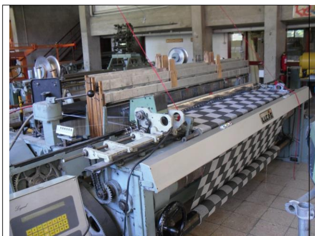
Figura 30 – Pormenor do processo de fabricação da camada intermédia.
