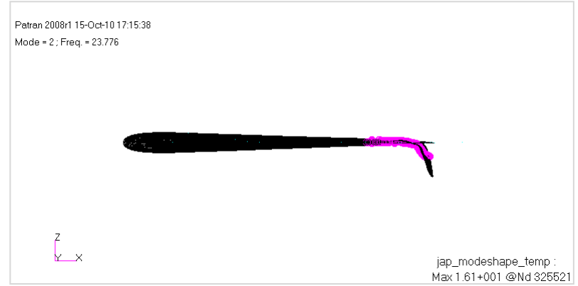
TE local Bending ; 23.8 Hz
