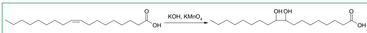
Figure 4-8 : Synthèse de l'acide 9,10-hydroxyoctadécanoïque avec le permanganate à partir de l'acide oléique.
