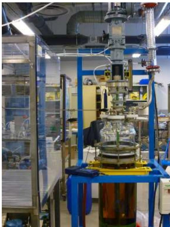
Figure III.5: Réacteur finisseur pour la destruction des SiH
