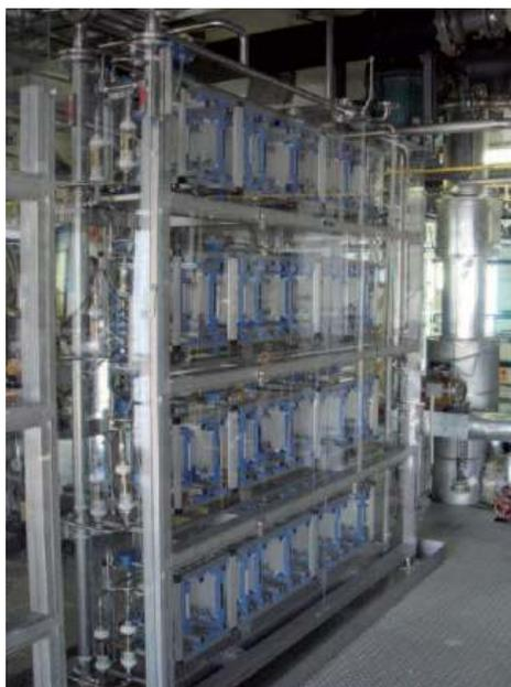
**Figure I.15: Procédé industriel final d'une nitrification sélective en continu, DSM&Corning**
