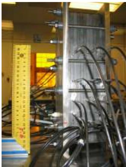
Figure I.22 : Le réacteur-échangeur en Carbure de Silicium
