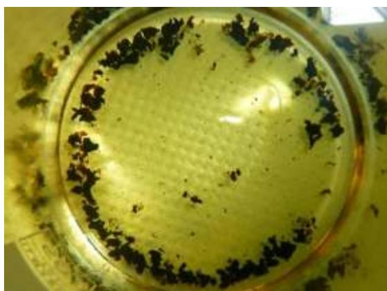
Figure III.16: Photographie de colloïdes catalyseur dégradé sous l'effet de la température
