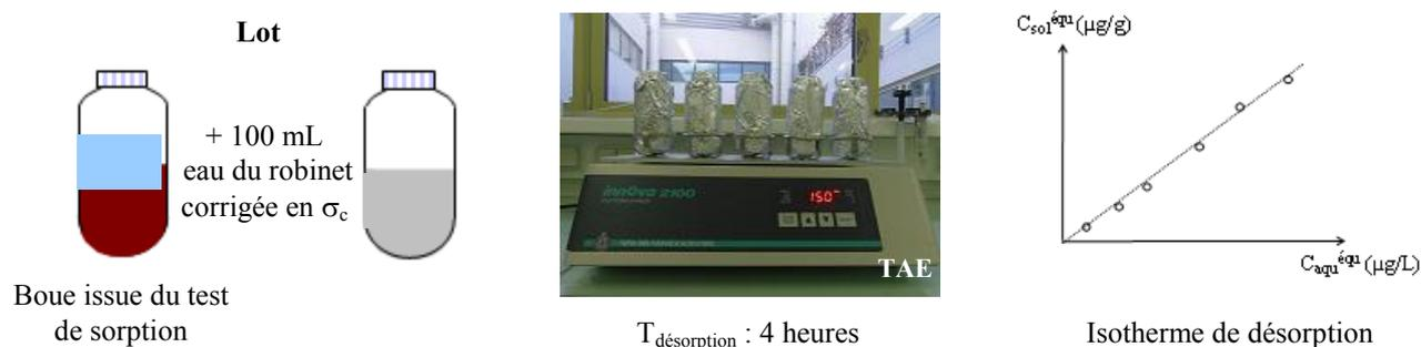
**Figure IV-19 : Principe des essais de désorption sur la boue contaminée**
