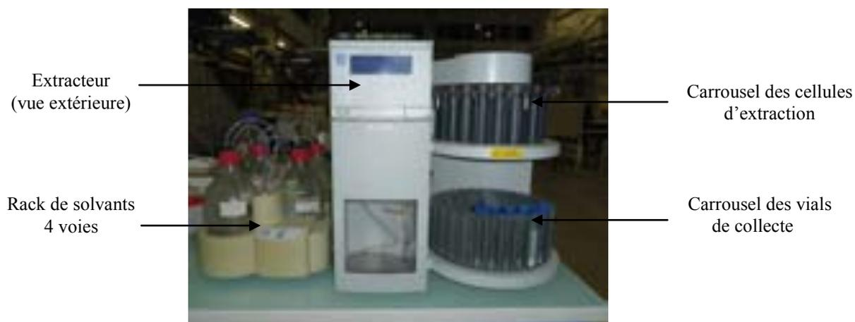
Figure II-9 : Matériel utilisé pour l'extraction par PLE
