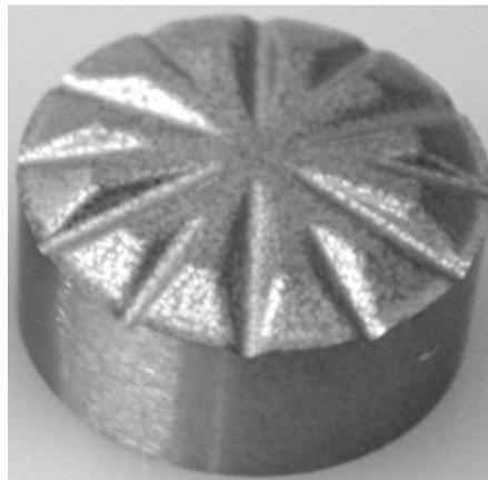
FIGURE 2.2.9 – Design d'interface PDC/WC-Co des taillants de l'étude.
