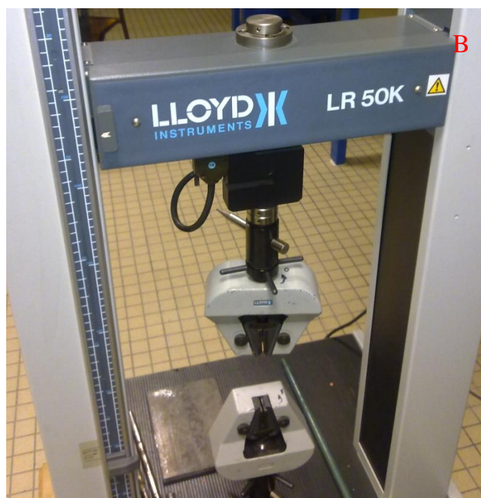
Figure II.13 Photo d'une éprouvette de traction standard réalisée par SLM (A); photo de machine d'essai LLOYD. Instruments Corp. LR 50K (B)
