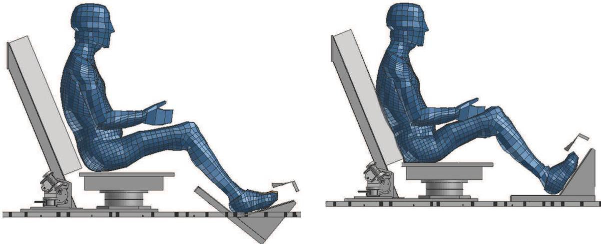
Figure 51. Positionnement du modèle Labman dans le siège (exemple pour les configurations 1 et 2).
