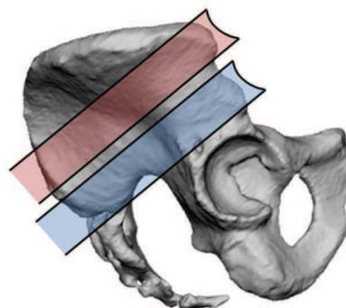
**Figure 84. Illustration de la limite de l'angle relatif entre la ceinture pelvienne et le bassin comme critère de sous-marinage.**
