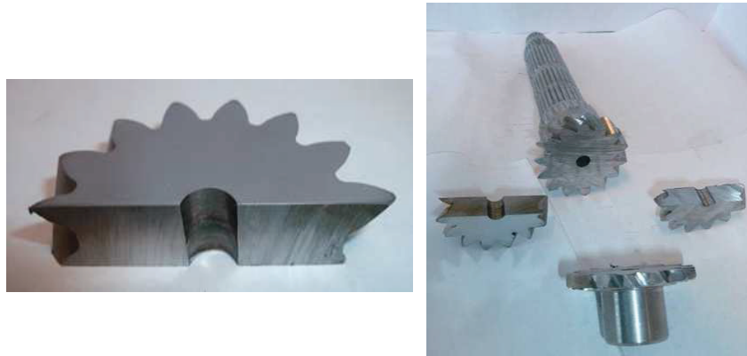
FIGURE 4.10 – Découpage de la denture pour observation métallographique dans le plan orthogonal à l'axe de la pièce.
