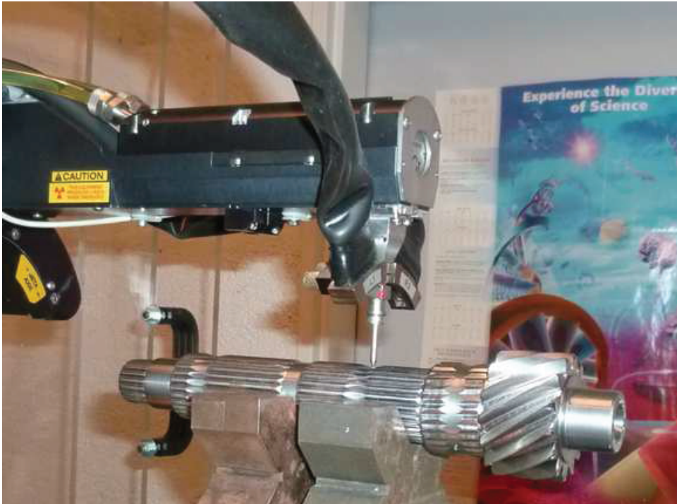
FIGURE 4.9 – Photographie du dispositif de mesure de contraintes résiduelles par diffraction rayons X utilisé sur un arbre secondaire après rasage.
