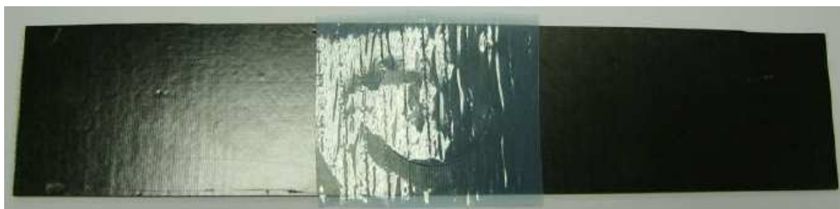
Figure IV.5 Mise en position des patchs durs avec un film démoulant [4]
