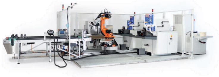
Figure 114 : Machines Sunnen avec chargement robotisé.
