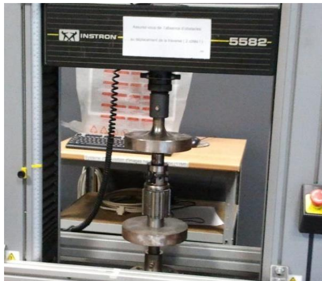
Figure 76 : Montage du Rodoir sur la machine de traction / compression.
