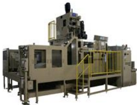
Figure 112 : Machine de rodage « transfert » Toyo.
