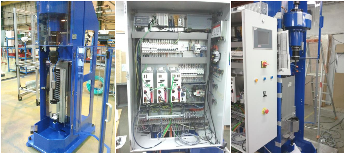
Figure 134 : Photographies de la machine nue à gauche, de l'armoire électrique au milieu et de l'interface utilisateur à droite.
