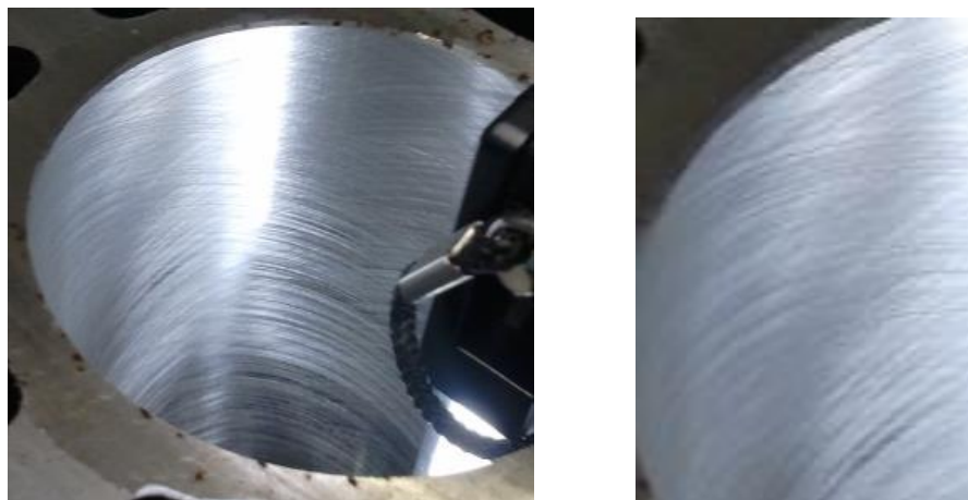
Figure 72 : Images de surfaces issues d'un rodage classique.
