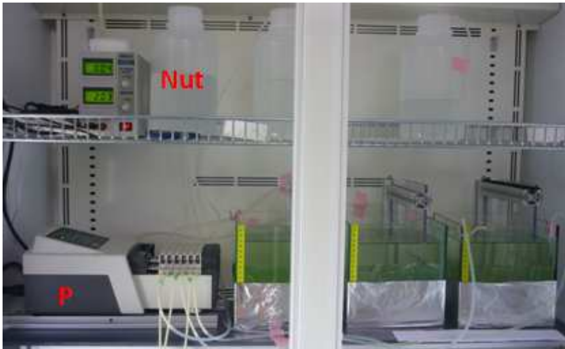
Fig. 2.4 a) Représentation schématique du dispositif de génération de la turbulence et b) photo représentant le dispositif pendant la modalité de faible turbulence. "Nut" indique la source en nutriments et "P" la pompe péristaltique qui contrôle l'apport de ces nutriments.
