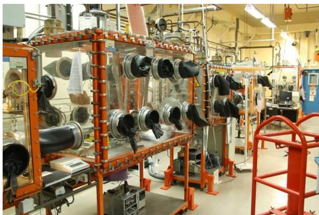
Figure 37 : Exemple de boîtes-à-gants à l'INB 123, assurant la première barrière de confinement de la matière
