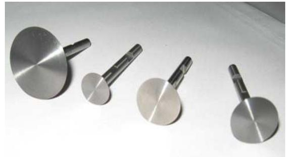
Fig. 2.28 Géométrie des cônes utilisés
