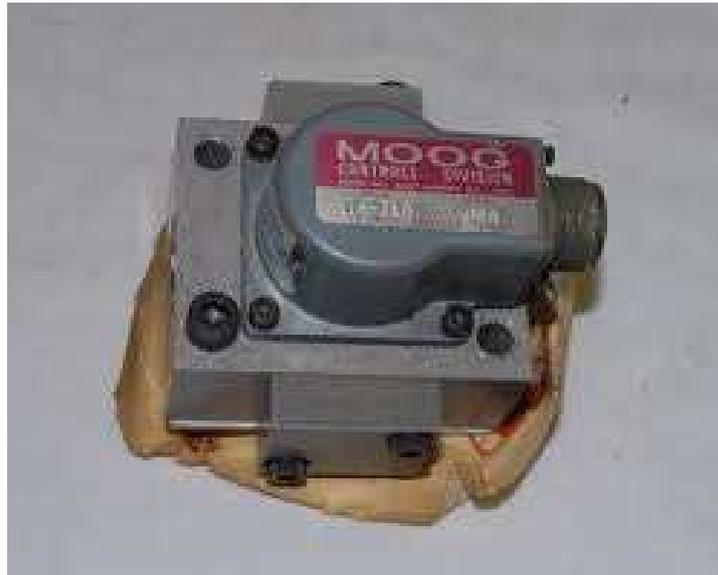
Fig. 2.7 La servovalve électrique
