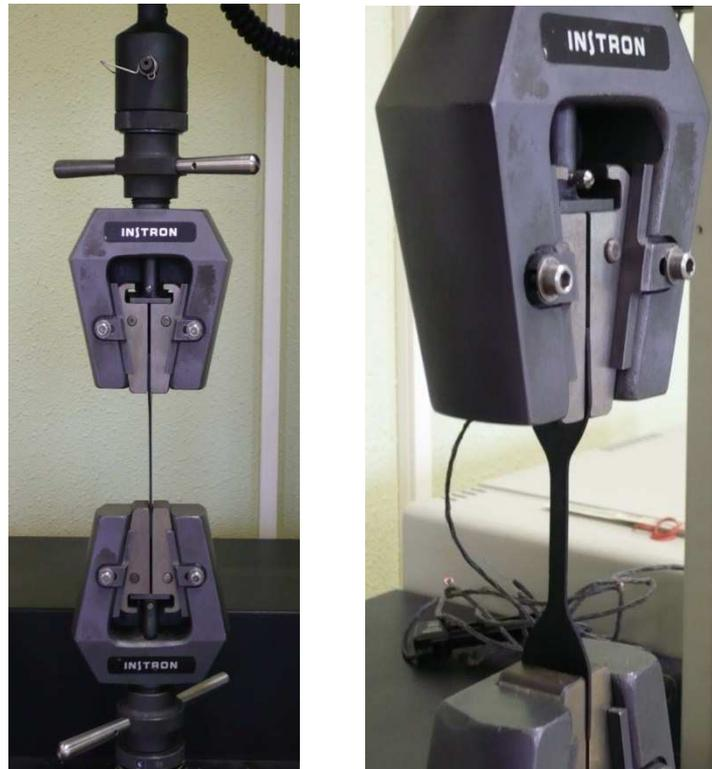
Fig. 2.22 Mise en place de l'éprouvette
