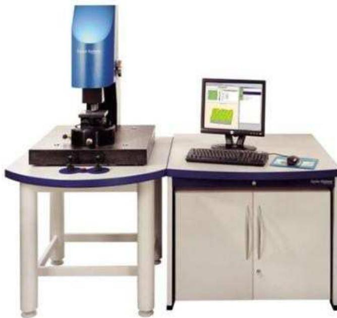
Fig. 2.12 Le dispositif de mesure optique de la topographie des surfaces (Taylor Hobson)
