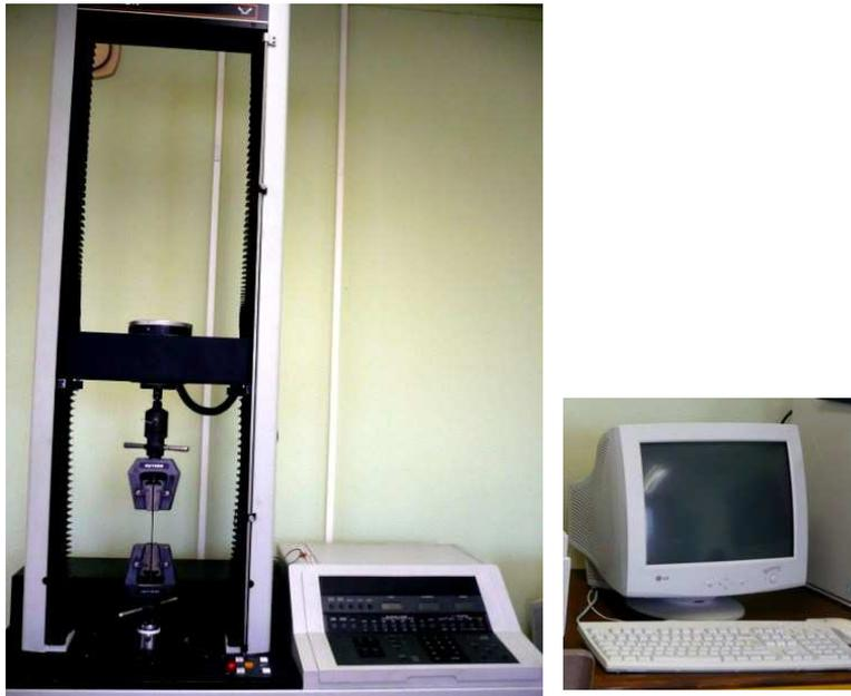
Fig. 2.20 Le dispositif expérimental de traction uni axiale
