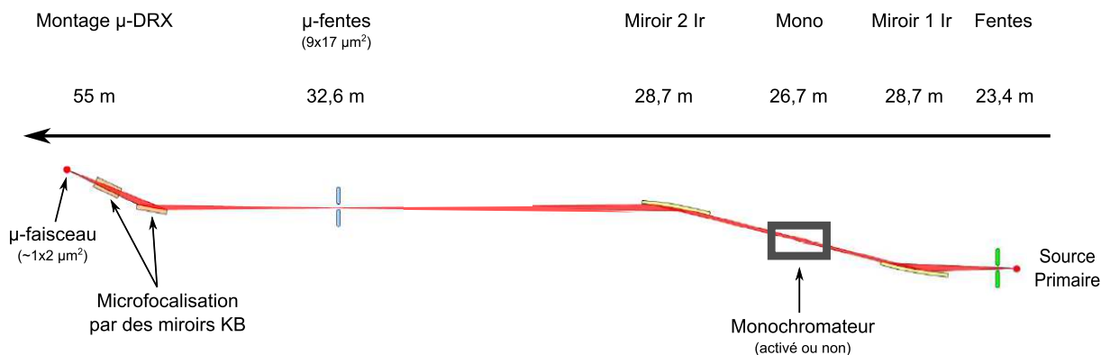
FIGURE 2.24 – Représentation schématique de la ligne BM32 à l'ESRF.
