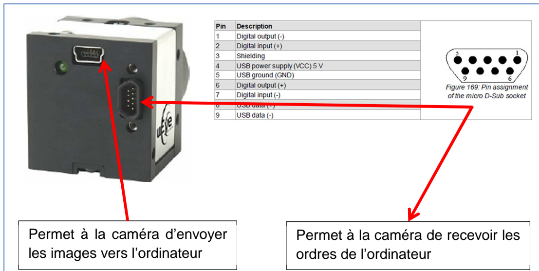
Figure 4-3 connecteurs de la caméra
