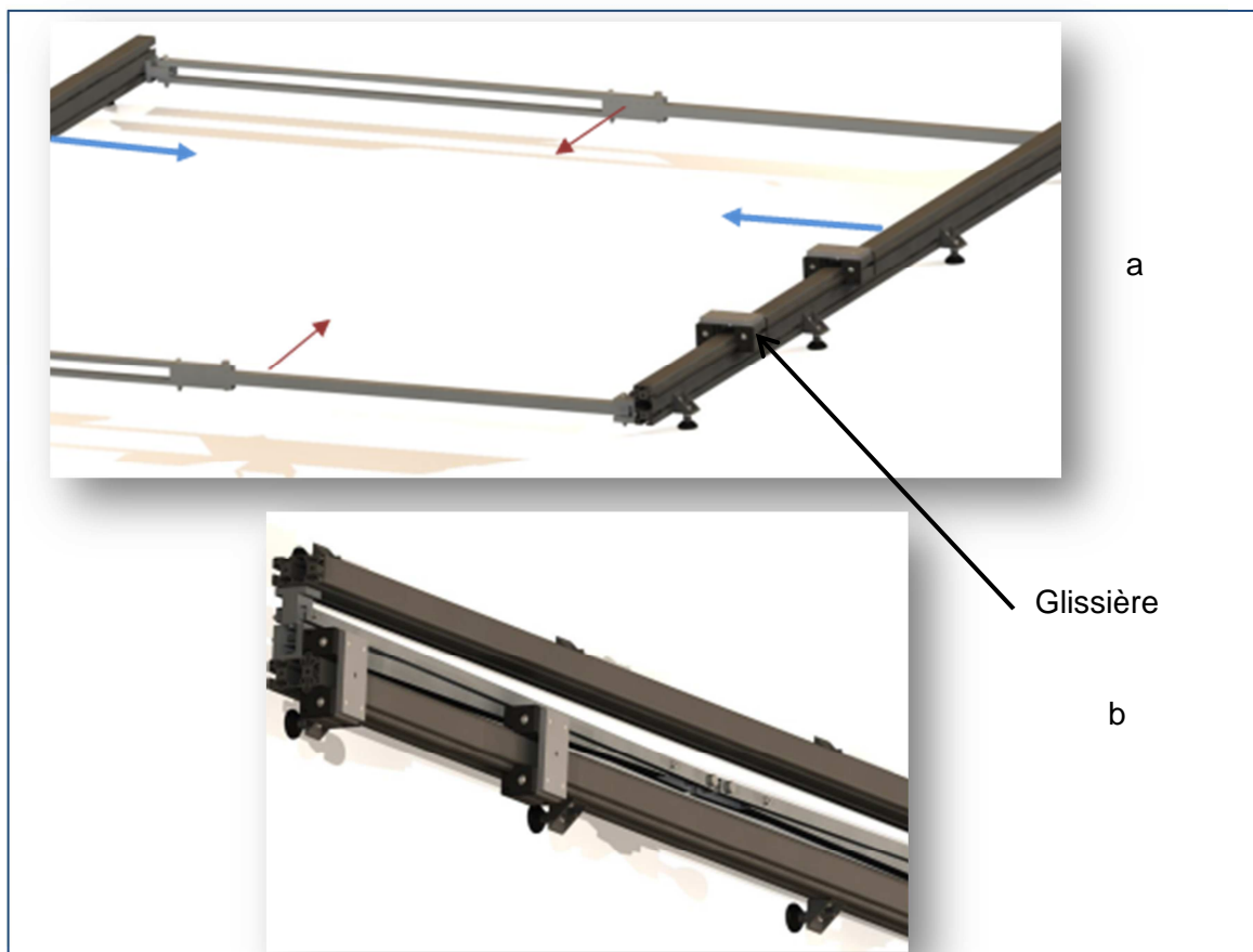
Figure 3-3 : Conception du rail- a) le rail déplié- b) rail plié
