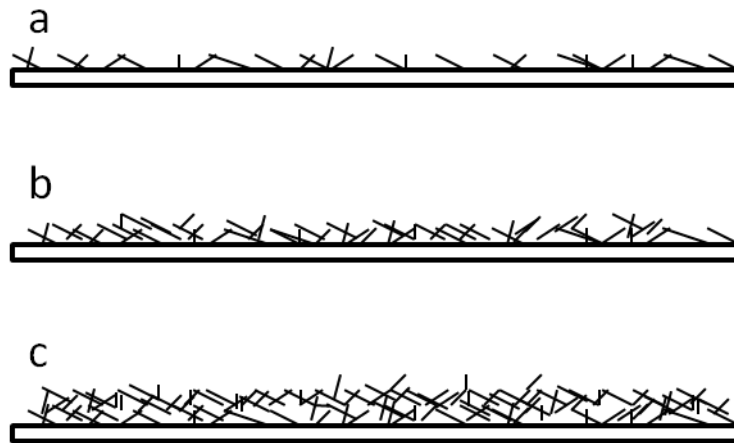
Figure III.6-3 : Représentation schématique d'un film de nanotubes vue de côté. De a vers c, l'épaisseur de la couche de nanotubes augmente pour finir par percoler.
