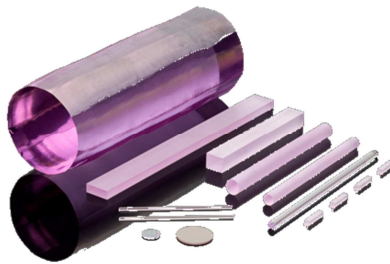
Figure 6 : Monocristal Nd:YAG pour milieu laser à solide (Scientific Materials Corp.) [24]
