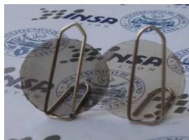
Figure 101 : Echantillons de YAG ( \varnothing = 20 mm) obtenus par SPS (15 min, 1350 °C, 74 MPa) après frittage (à gauche), (e = 1,4 mm) et après recuit d'une heure à 800 °C (à droite) (e = 1,3 mm) [141]
