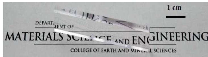
Figure 12 : Céramique Er:YAG à gradient de dopage 0%, 0,25% et 0,5% [7]
