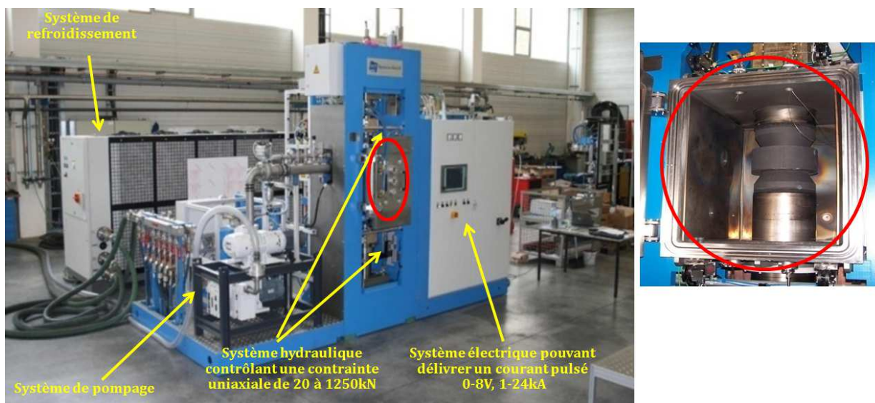
Figure 102 : Machine SPS HP-D125 de l'Université de Bourgogne (FCT Systeme GmbH)
