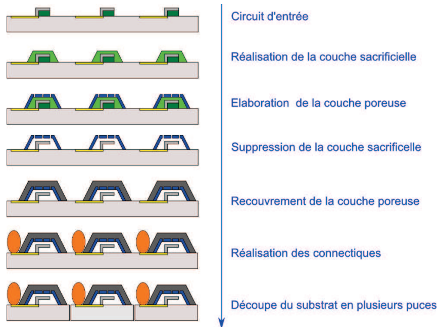
Figure 2-4 : Principe du procédé d'encapsulation par couche sacrificielle
