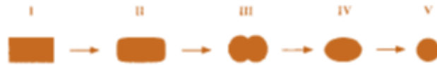
Figure 21 : formation des sphéroïdes selon Rowe (1985) : I : extrudat, II : cylindre arrondi, III : haltère, IV : sphère elliptique, V : sphère
