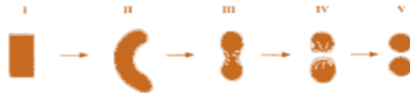
Figure 22 : formation des granules selon Baert (1993) : I : cylindre, II : cordon, III : haltère, IV : sphère avec une cavité extérieure, V : sphère
