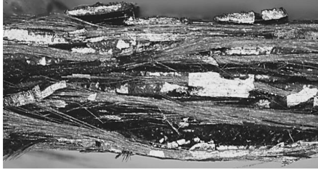
Figure 15 : Mise en évidence du délaminage des éprouvettes vieillies sollicitées en traction jusqu'à rupture ( \Delta m/m_0 \approx -5\% ).
