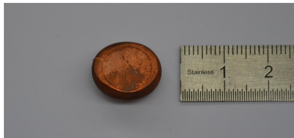
FIGURE 13.14 Eprouvette de CuD35-E après compression à T = 25^{\circ}\text{C} et \dot{\varepsilon} = 10 \text{ s}^{-1}
