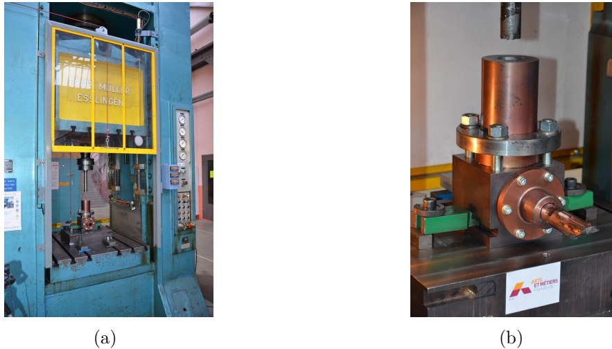
FIGURE 12.5 Mise en œuvre du procédé ECAE : (a) Presse Müller ; (b) Outillages
