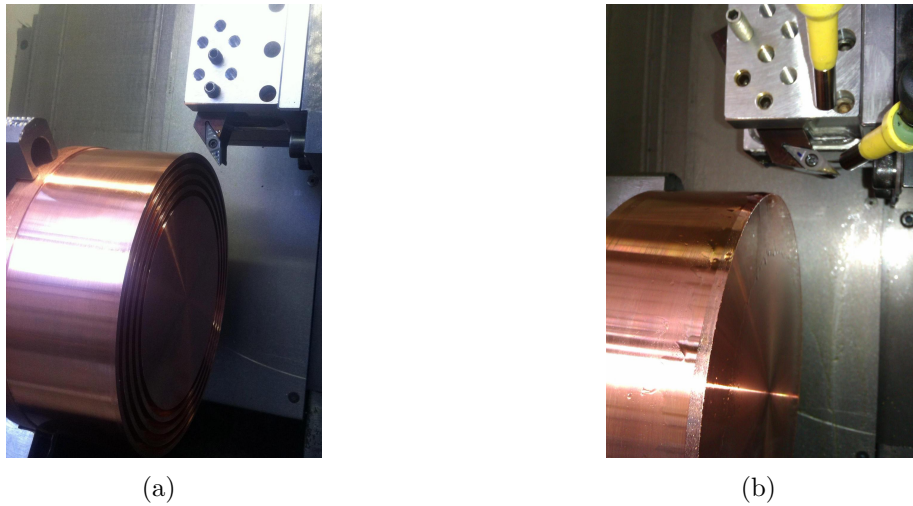
FIGURE 10.5 Essais instrumentés de coupe orientée : (a) sur tube ; (b) sur coin
