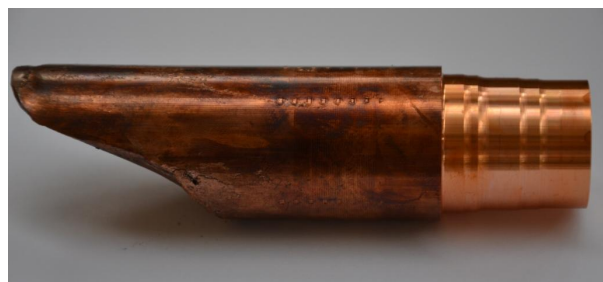
FIGURE 14.1 Lopin CuD35-E à l'issue des essais de chariotage
