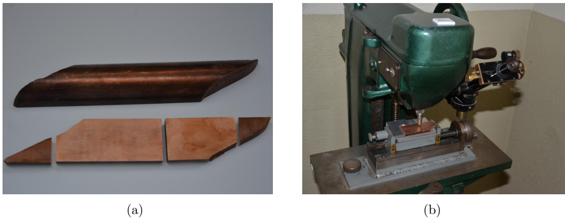
FIGURE 13.2 Vérification de l'homogénéité : (a) Echantillons utilisés ; (b) Machine de dureté Vickers
