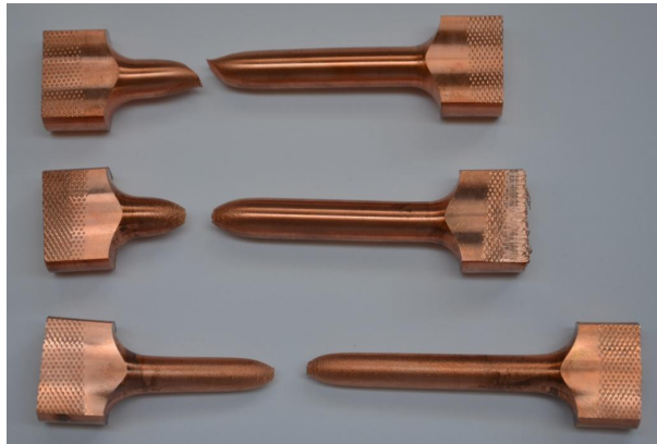
FIGURE 13.7 Eprouvettes de traction après rupture; de haut en bas : CuD35-E, CuD35-S et CuD35-R
