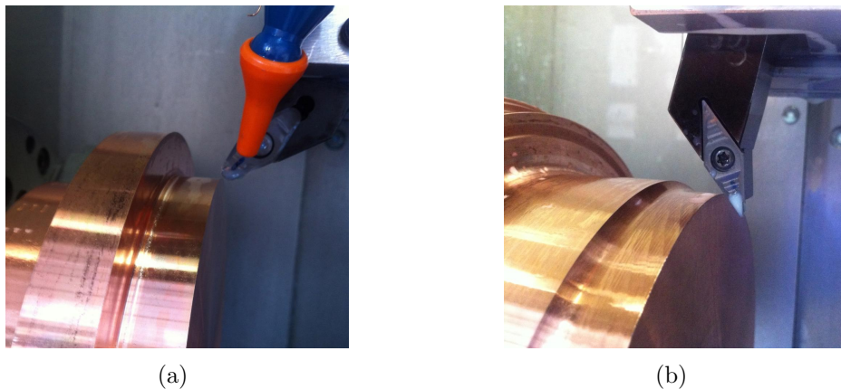
FIGURE 10.20 Essais de coupe dans le bec sur coin : (a) r_\epsilon = 3 mm ; (b) r_\epsilon infini (arête rectiligne)
