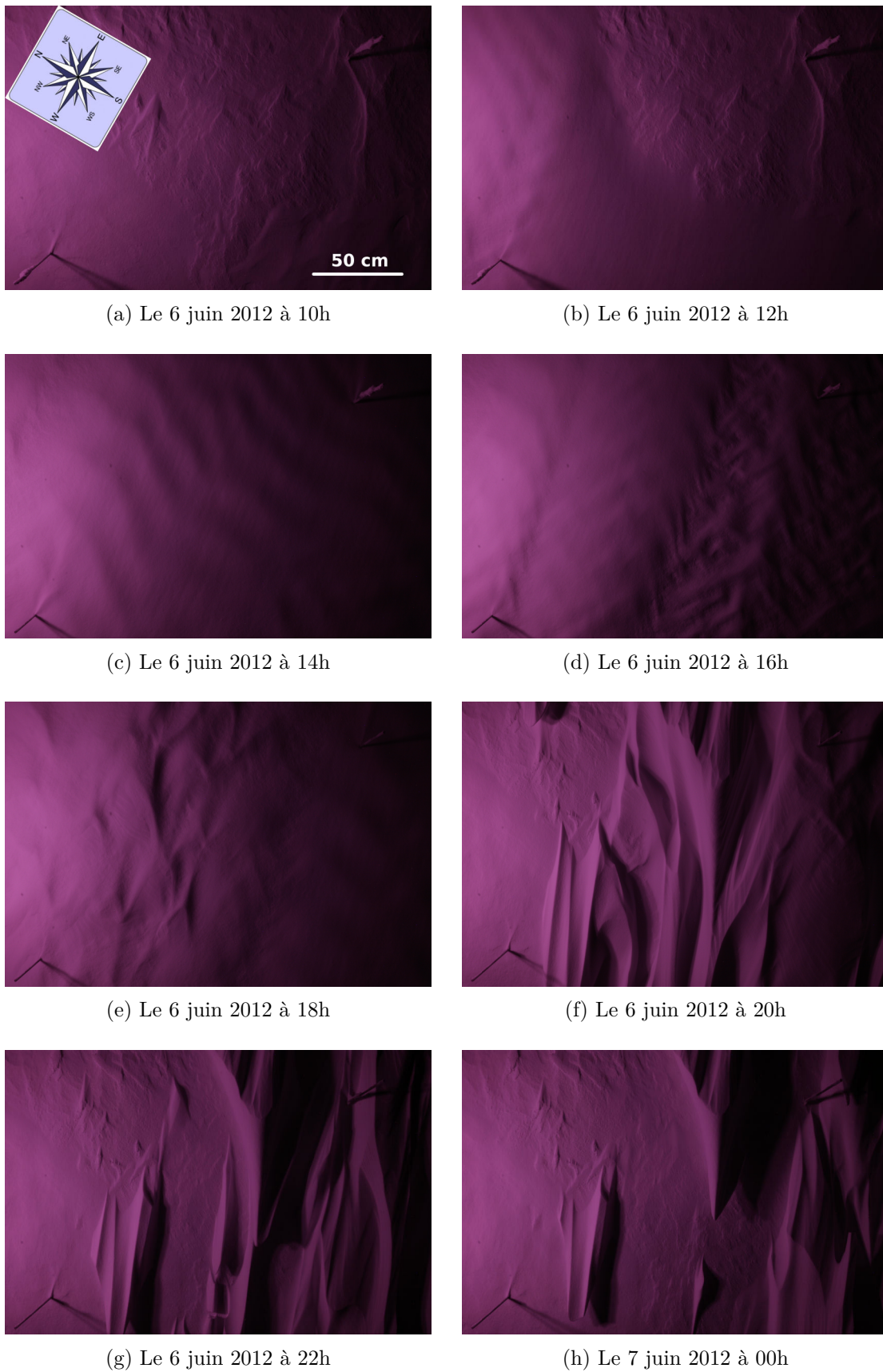
FIGURE 3.6 – Séquence de photos infrarouges, prises toutes les deux heures pendant le mois de juin 2012, et montrant une évolution très rapide des reliefs formés sur la surface.
