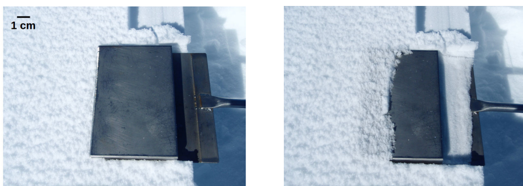
(a) Mesure de la densité D_1 , le haut de la pelle correspondant au sommet des cristaux de givre (b) Mesure de la densité D_2 , le haut de la pelle correspondant au bas des cristaux de givre
