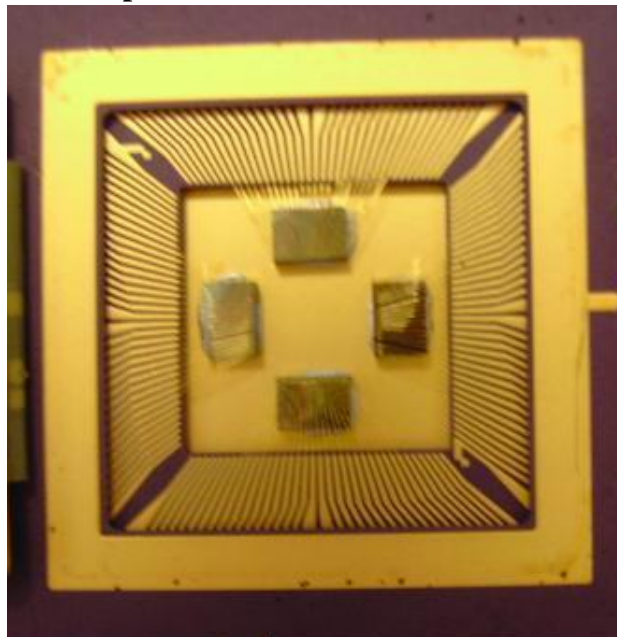
Figure 128 : photographie du démonstrateur comprenant quatre puces
