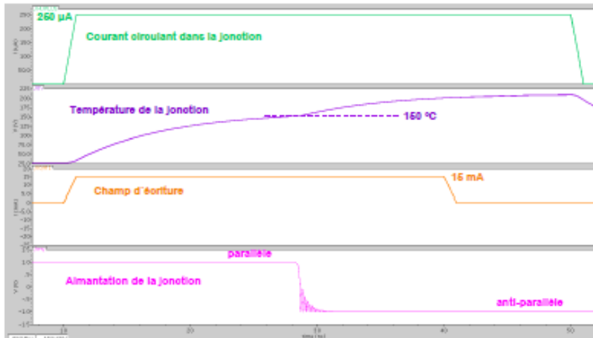
Figure 53 : cycle d'écriture d'un JTM en technologie TAS [16]
