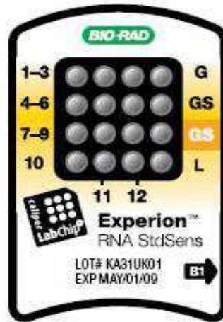
Figure 40 : Schéma d'une puce utilisée pour l'analyse de la qualité des ARN (www.bio-rad.com).
