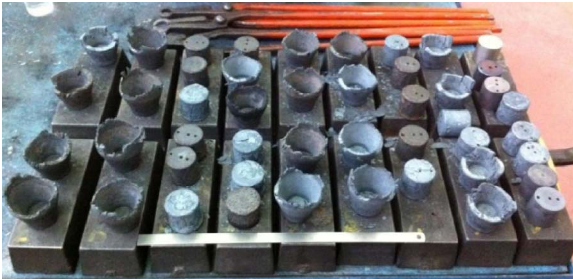
Fig. 4.1. Pièces obtenus par thixoforgeage.
