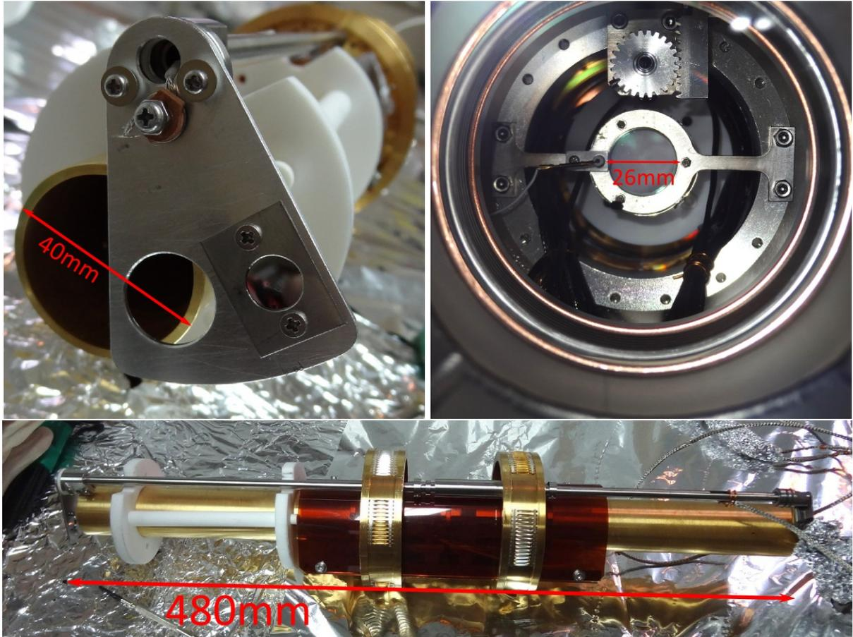
FIGURE 4.21 – Photos du remodérateur et de sa structure mécanique amovible. En haut à gauche, le porte remodérateur. Le remodérateur est vissé sur la structure. A sa gauche, l'orifice permettant le passage des positons. En haut à droite, la roue dentée qui transforme le mouvement du moteur pas à pas en mouvement de rotation de la tige du remodérateur. Sous la roue on peut voir l'écran phosphore. En bas, le bloc d'extraction des électrodes avec la tige de rotation du remodérateur.
