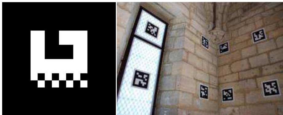
Figure 2.2 : Principe du marqueur « code barre » dont la reconnaissance permet au système de calculer la pose de la caméra et d'orienter la scène virtuelle en conséquence
