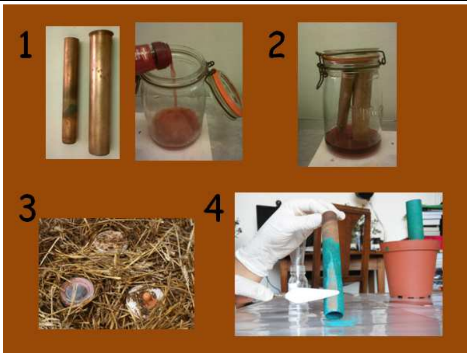
Figure IV-2 : Reconstitution du vert de gris [Menouer, 2011]. 1: les « ingrédients » : le tubes de cuivre polis et le vinaigre à 7%; 2 : le cuivre est mis dans le vinaigre; 3: le pot est posé dans le crottin de cheval pendant 20 jours; 4 : le pigment est obtenu en grattant les produits formés sur les tubes de cuivre.
