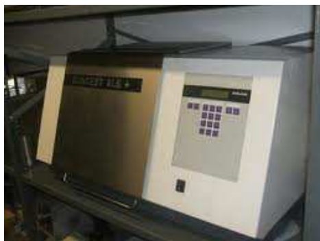
Figure A-4 : Système de vieillissement à la lumière
