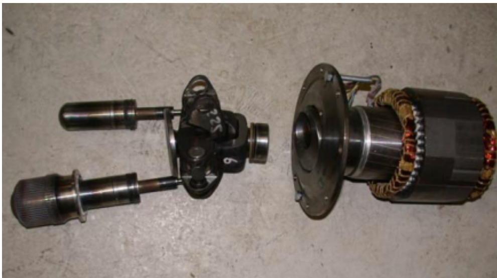
Fig. 9.8. Platoul oscilant și alternatorul [189].
