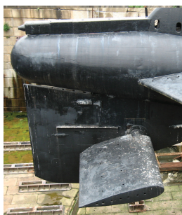
(b) Barre de plongée arrière du sous-marin britannique HMS Ocelot
