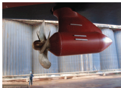
(e) Pod Mermaid de Rolls-Royce installé sur le BPC Dixmude (source : Mer et Marine)
