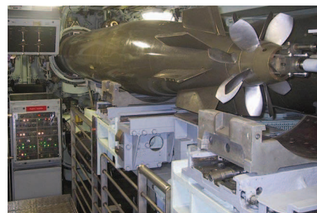
(f) Hélices contrarotatives d'une torpille L5 à bord du Redoutable (source : wikipédia)
