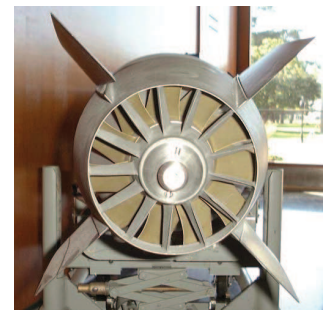
(c) Propulseurs de type pompe hélice sur une torpille mark50 (source : US Navy)
