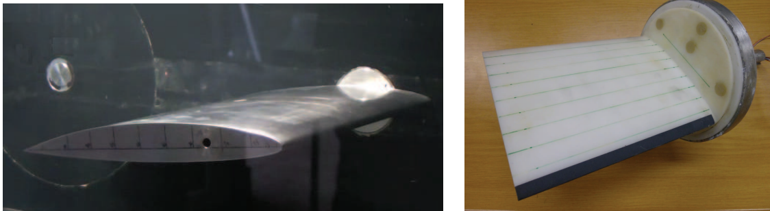
FIGURE 2.2 – Photos des profils portants rigide à gauche et flexible à droite (Le profil flexible est équipé de sa bande rugueuse)
