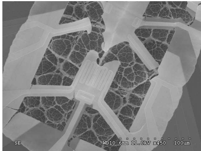
FIGURE 19 – Dispositif après libération par attaque chimique gazeuse.
