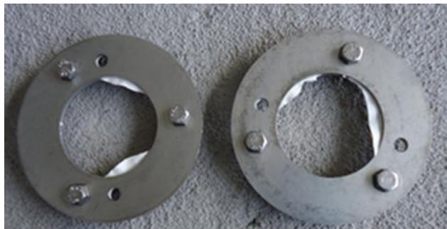
Figure 52 - Etat des membranes de POCIS après trois jours d'exposition dans l'effluent de la STEP B
