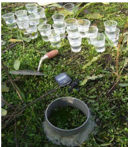
Figure 4-7. Mesure de la capacité d'infiltration locale, à partir de l'estimation de K_s , avec l'anneau simple.
